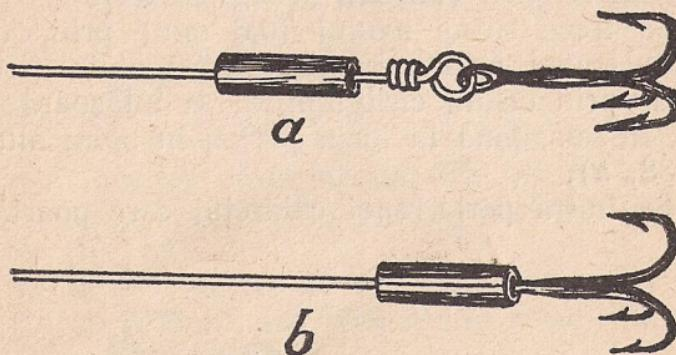
Fig. 37. Articulare semi-rigidă a cîrligului
