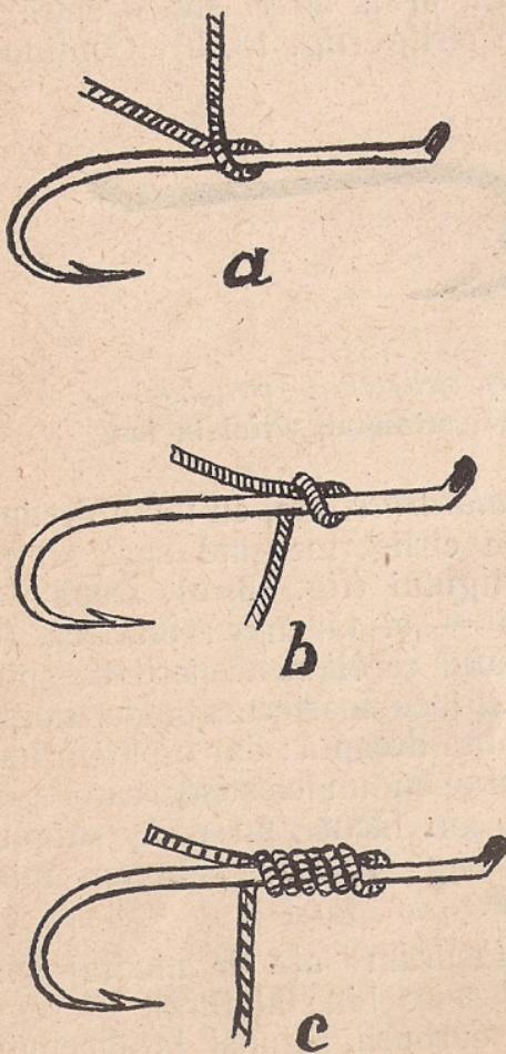
Fig. 13. Fixarea apei de montaj pe cîrlig
