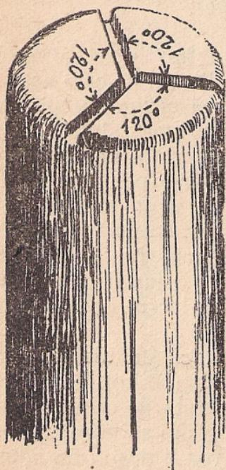
*Fig. 49. Șablon pentru confecționarea cîrligelor triple*
