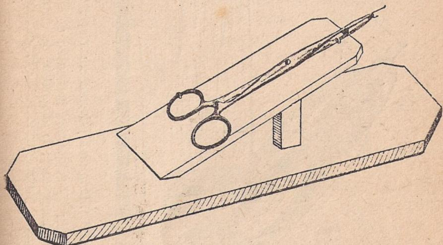
*Fig. 2. Clește chirurgical pentru improvizat menghina*
