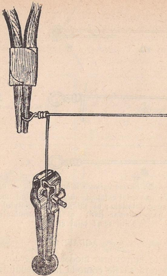
Fig. 28. Execuția unei bucle, cu cleștele rotund și menghină de mînă
