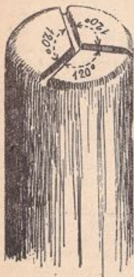
Fig. 49. Șablon pentru confecționarea cîrligelor triple
