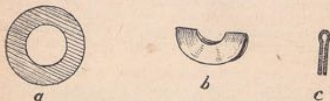
Fig. 41. Antirăsucitor din disc de plumb a) discul de plumb ; b) îndoit pentru întrebuințare ; c) secțiune
